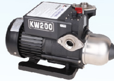
ปั๊มหอใย วัตต์ KW200 3/4" X 1/4HP ตรา Black Eagle คุณสมบัตินี้เหมือนปั๊มกัน หยุด วัตต์ในวัตต์ มีระบบป้องกันมอเตอร์เสียหายกรณีไม่ มีน้ำเข้า ขนาดท่อ 3/4" ดัดลึก 6 เมตร แรงส่ง 20 เมตร ปริมาณน้ำ 50ลิตรต่อนาที Made in Taiwan
